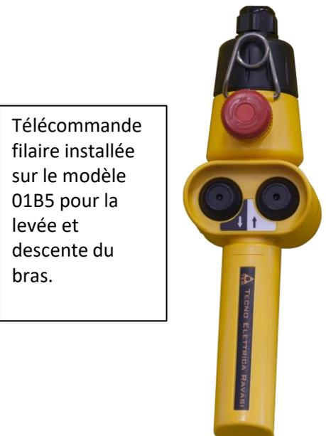
Télécommande filaire installée sur le modèle 01B5 pour la levée et descente du bras.
