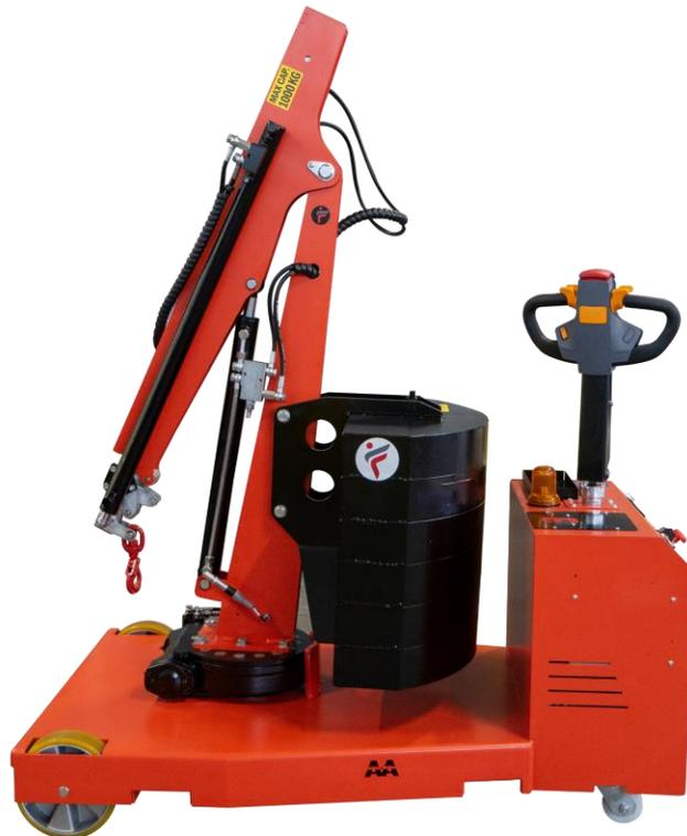
FLEX G1000DB est une grue motorisée rotative à contrepoids qui permet de soulever et de transporter des charges jusqu'à 1.000 kg. Mât sur tourelle rotative électrique. Équipée de 2 roues fixes et de 2 roues stabilisatrices pivotantes. Roue motrice auto-freinante pour une maniabilité aisée dans les espaces confinés. Conforme à la réglementation en vigueur pour la protection et la sécurité des opérateurs.
